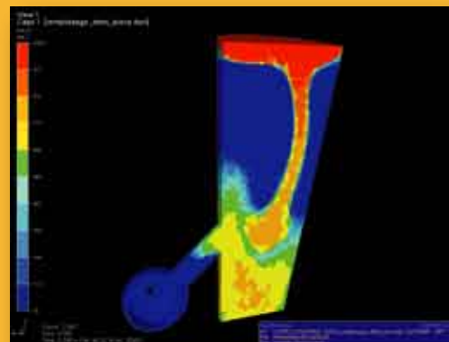
Simulation du remplissage du moule par l'or liquide
