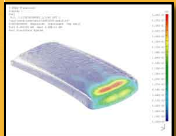
Toit supérieur polyester (Simulation des déformations dues au vent de bout, 250 km/h)
